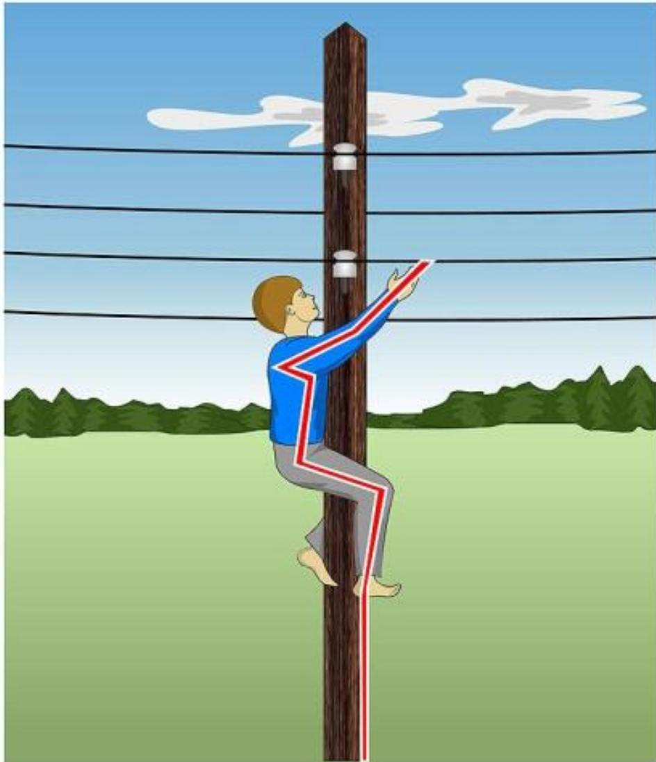
**ОПАСНО влезать на опоры высоковольтных линий электропередачи!**
